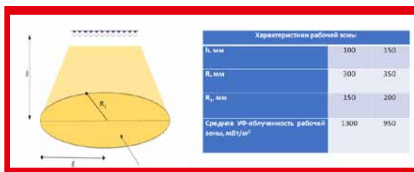
Рис. 5. Характеристики рабочей зоны УФ-облучателя UVLINE LED
